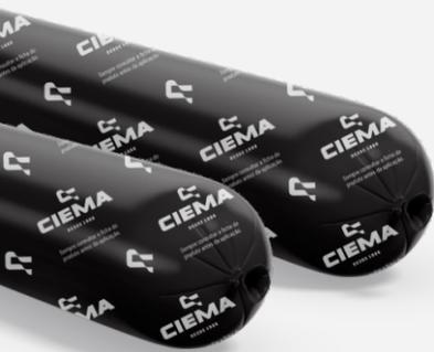
**CIEMA SMP INDÚSTRIA** é um produto de silano modificado de poliuretano, monocomponente de alta resistência, que cura reagindo com a umidade do ar para formar um produto elástico, macio e de forte aderência. Ótima aderência em metais (aço, galvanizado, galvalume e alumínio), vidros, madeiras, concreto, alvenaria, além de grande variedade de plásticos.
